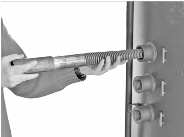
Fig. 9: Enfiar a lança de carregamento e vedá-la
