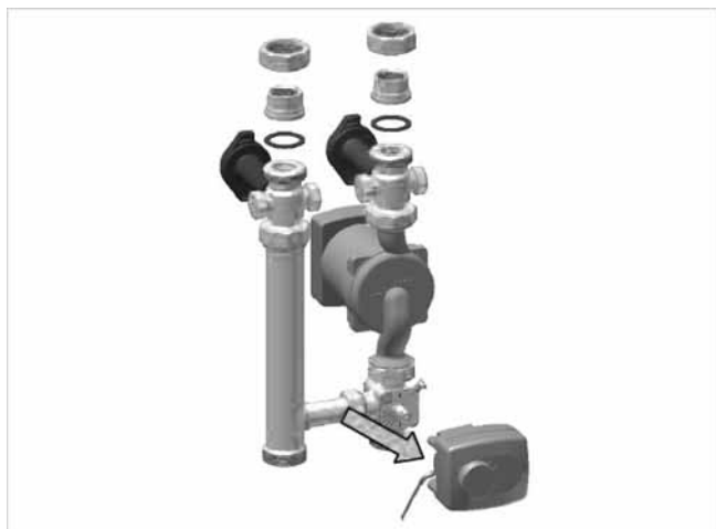
Afb. 15: aandrijfeenheid van de mengklep lostrekken
